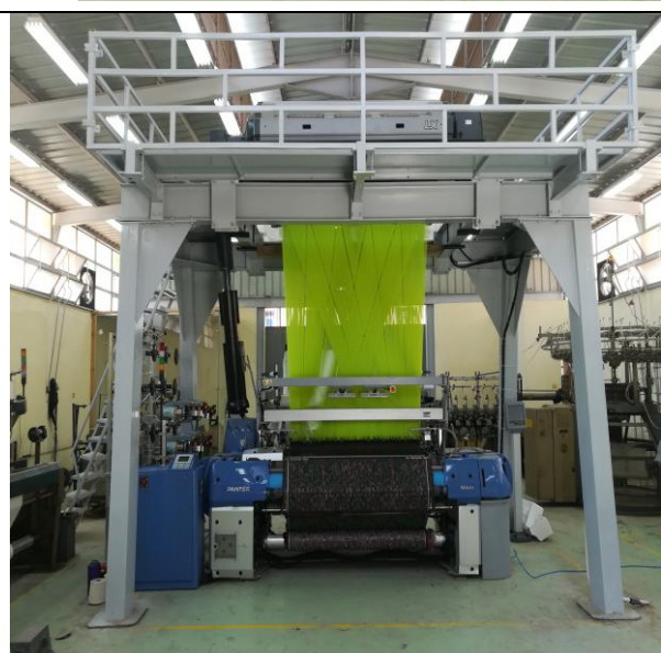
صور توضح ماكينة النسيج ( panter rapier ) عرض ١٩٠ مزودة بجهاز إلكتروني ( stubli ) ٢٠١٩
