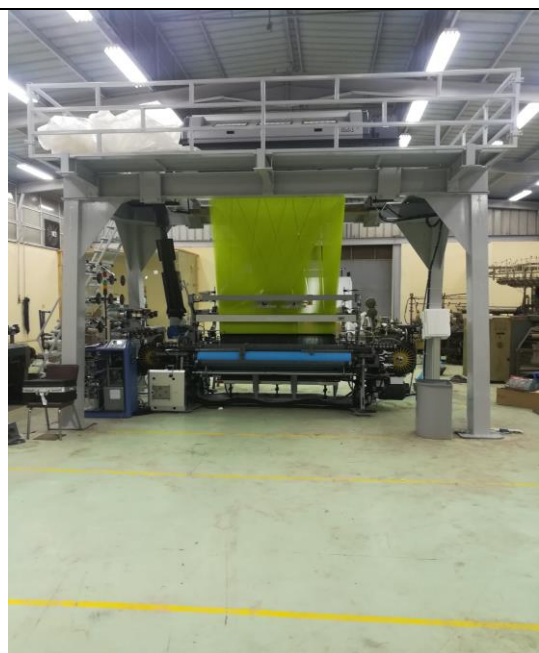
صور توضح ماكينة التريكو الجاكارد ( الحديثة ) موديل ( shina star 2019 )
