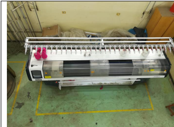
صور توضح ماكينة التريكو الجاكارد ( الحديثة ) موديل ( shina star 2019 )
