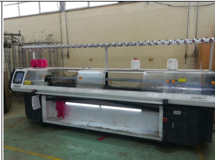
صور توضح ماكينة التريكو الجاكارد ( الحديثة ) موديل ( shina star 2019 )
